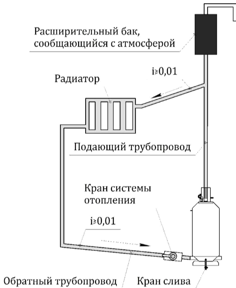
Рисунок 13 – Схема открытой системы отопления с естественной циркуляцией
